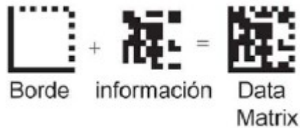
Figura N° 3.- Estructura de un Datamatrix (Sivart, 2017).
