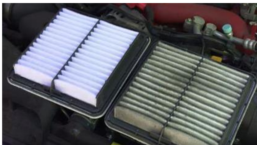
Fig.1. Filtro de aire a partir del (papel plisado)
