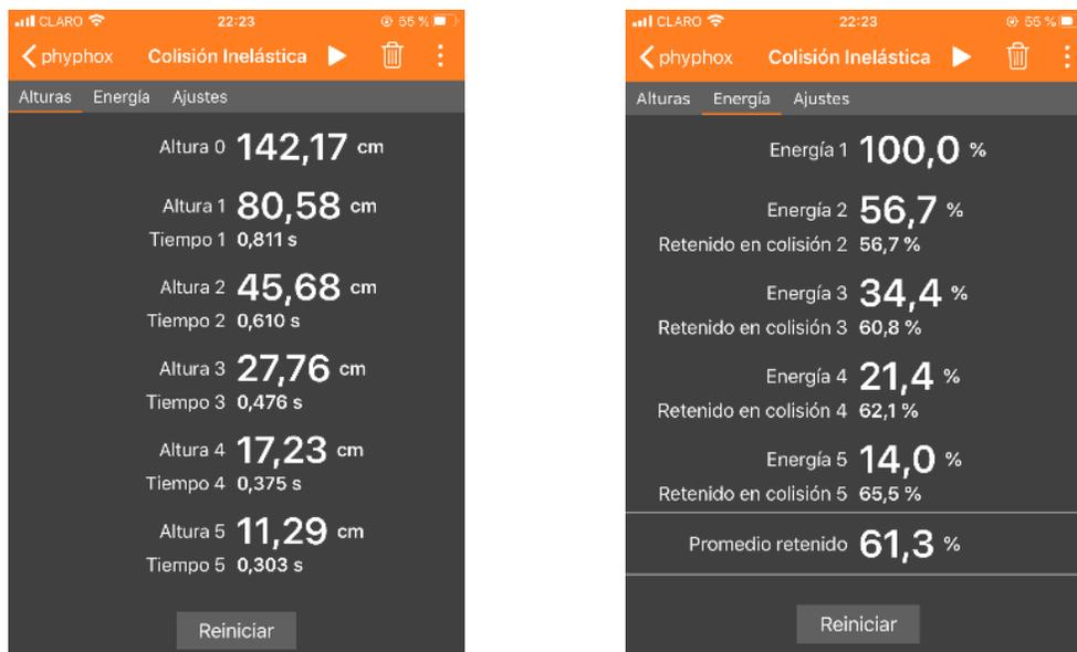
Figura 5. Datos obtenidos en el simulador informático phyphox para el experimento 3
