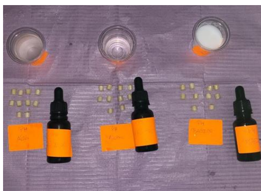
Figura 10: Almacenamiento de las muestras en frascos ámbar con diferentes soluciones
