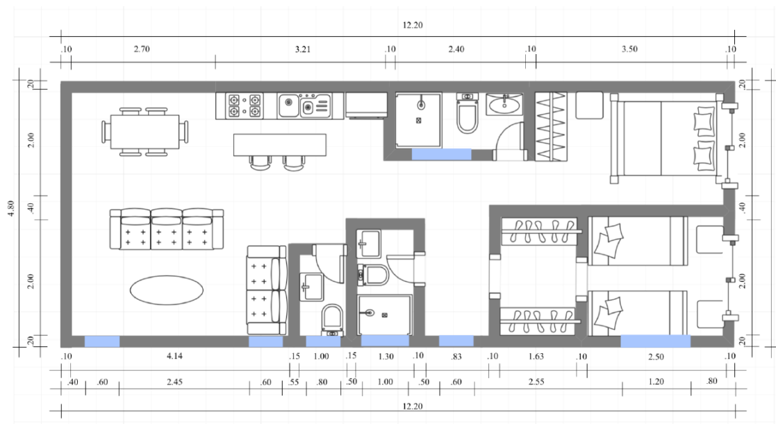
Figura 8: Diseño prototipo I de 58.56 m 2 con 2 contenedores.
