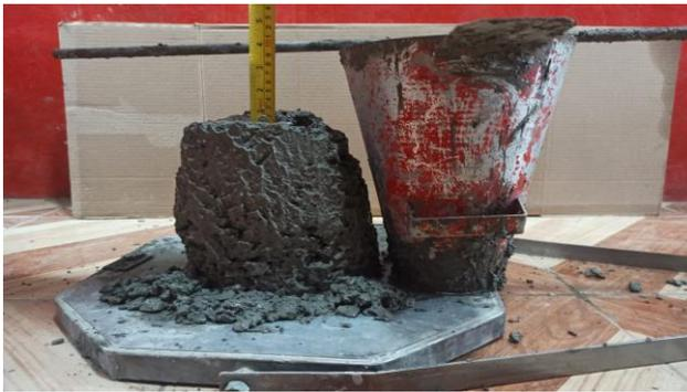
**Figura 2.** Ensayo de revenimiento relación a/c 0.40.
