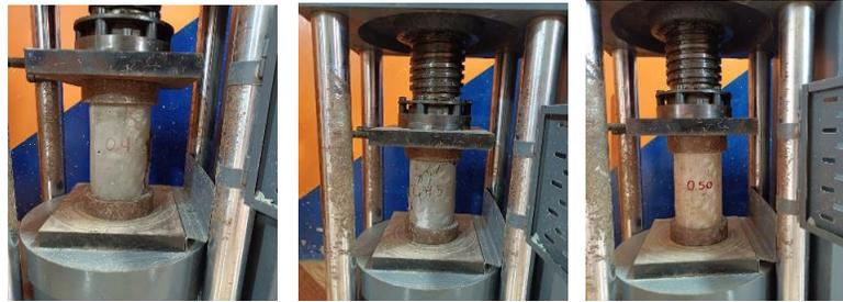
**Figura 4.** Ensayo con máquina de compresión cilíndrica a) 0.40 b) 0.45 y c) 0.50.
