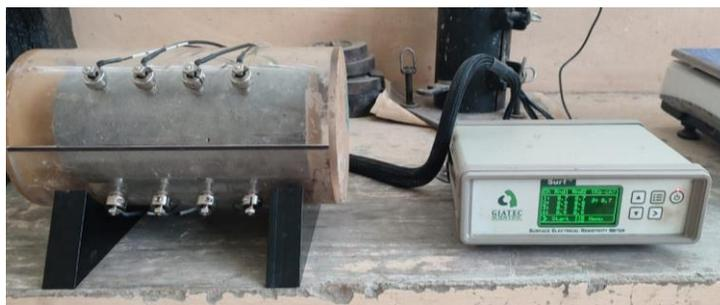
**Figura 3.** Ensayo de resistividad eléctrica con dispositivo Surf<sup>TM</sup>.
