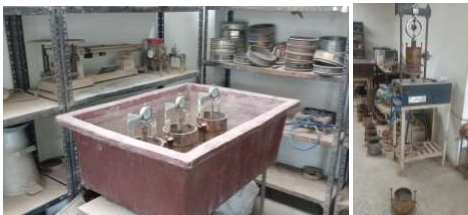
Fig. 3. Análisis de CBR y medida de punzonamiento estándar sobre muestras identificadas
