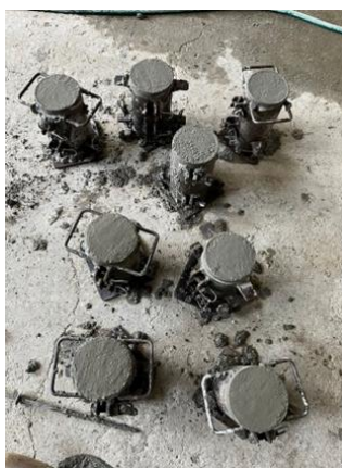
Figura 1 Cilindros de Hormigón
