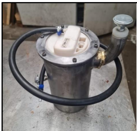
Figura 4: Mecanismo Tanque – Bomba auxiliar.
