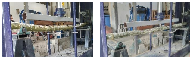
Fig. 5 y 6. Probetas sometidas a esfuerzos de flexión.
