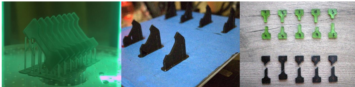
Figura 9: Probetas antes y después del ensayo de tracción
