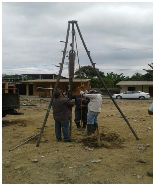
Figura 2: Ensayo de Penetración Estándar (SPT) realizado en la ciudad de Calceta.
