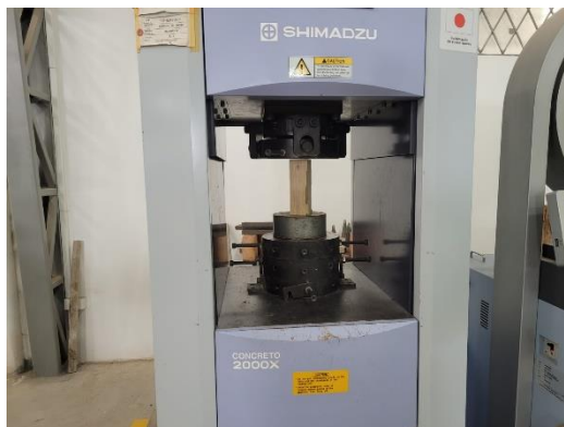
Ilustración 9 ensayo de compresión probeta sin curado
