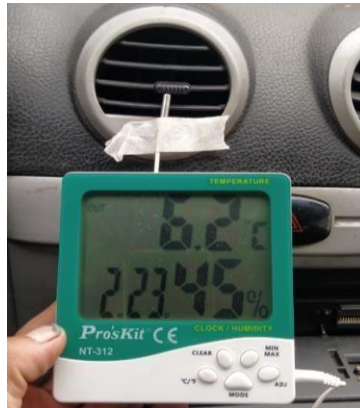
Fig. 10. Medición de temperatura y humedad a la salida del A/C
