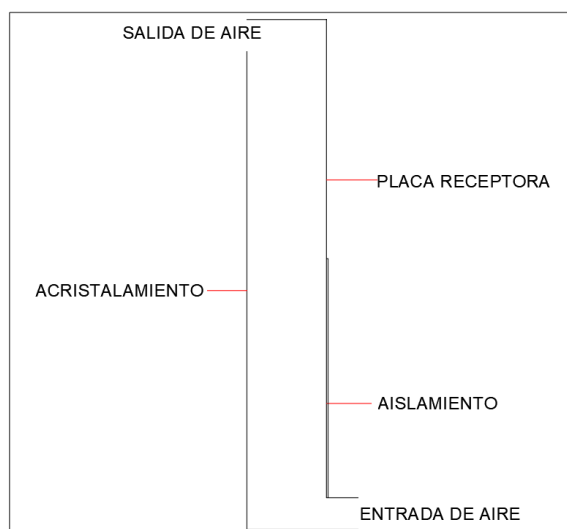
Figura 1: Esquema chimenea solar. Fuente: Propia
