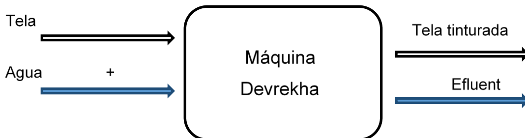
Figura 4: Balance de masa en la máquina Devrekha
