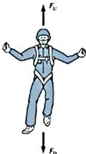
Esta figura es la representación matemática de las fuerzas que actúan sobre un paracaidista en descenso  $FD$  es la fuerza hacia abajo debida a la atracción de la gravedad.  $Fv$  es la fuerza hacia arriba debida a la resistencia del aire.
