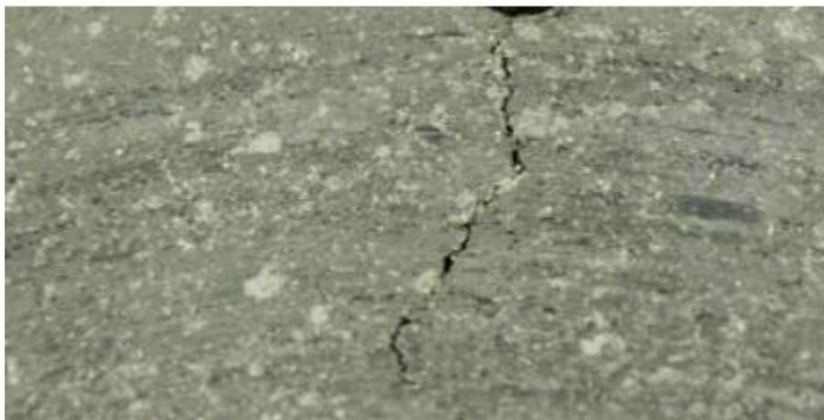
**Figura 13:** Grietas en la superficie de la pastilla de freno
