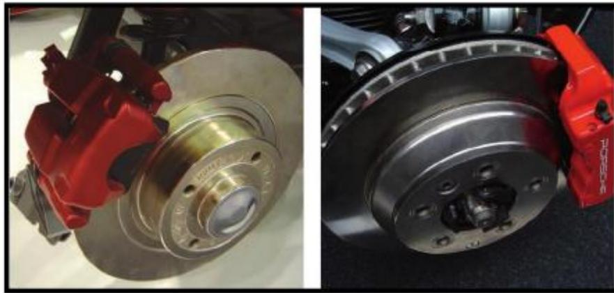
**Figura 3:** Discos de Frenos no ventilado (izquierda) y ventilado (derecha)
