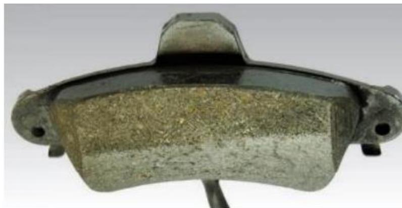
**Figura 15:** Patrón de contacto insuficiente en pastilla de freno
