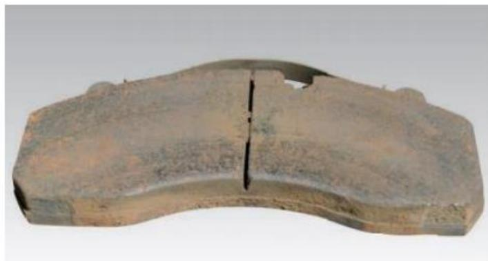
**Figura 10:** Pastilla dañada por destrucción térmica
