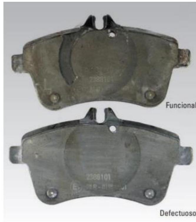
**Figura 16:** Marca visible en la placa de soporte de la pastilla
