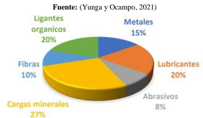
Figura 7: Composición de las pastillas de freno
