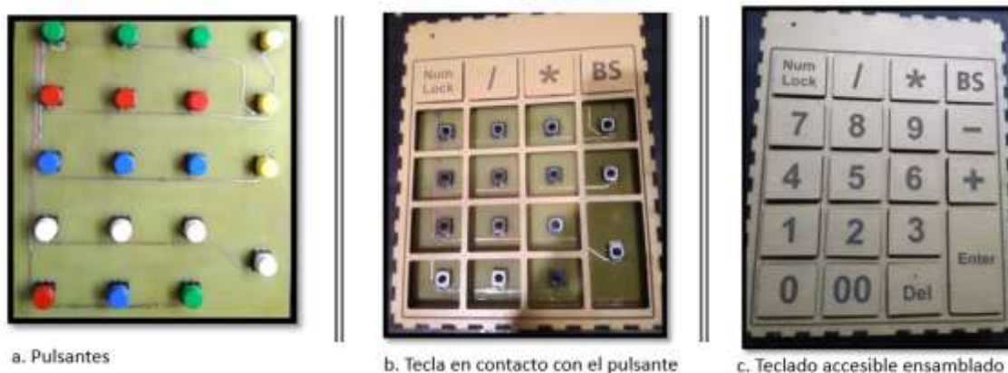
Figura 12: Fotografías del teclado desarrollado
