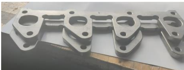
Figura 12: Soporte que une el sistema de escape al block del motor del vehículo Chevrolet corsa 1300 cc.
