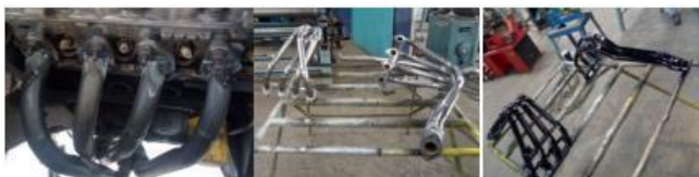
Figura 14: A) Soldadura eléctrica de los tubos B) pulida externa C) Pintada del múltiple terminado
