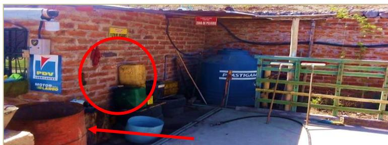
**Figura 12.** Recipientes inadecuados de almacenamiento de aceite lubricante usado.
