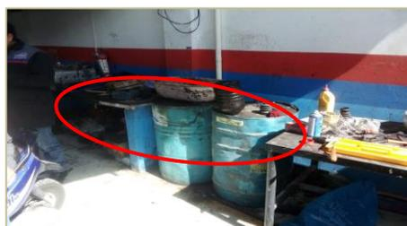
**Figura 11.** Depósitos de lubricante usado sin sistema de filtrado primario.
