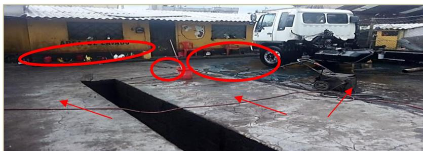
Figura 14. Limpieza de aceite lubricante del piso mediante agua con detergente.
