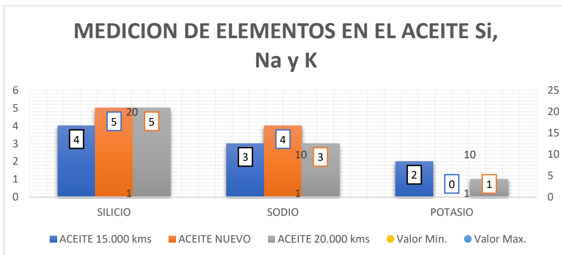
Figura 11. Medición de elementos en el aceite Si, Na y K.
