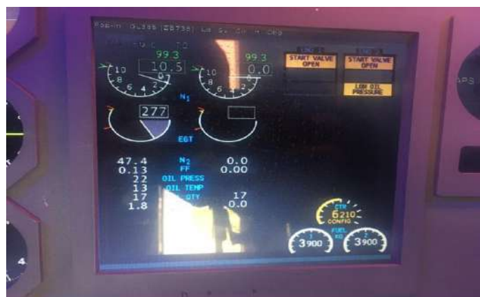
Figura.29. Funcionamiento de la pantalla primaria EIS
