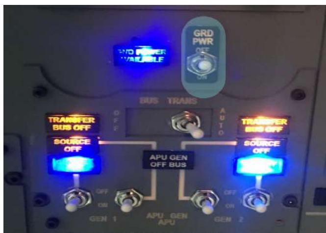
Figura.21. Interruptor ground power en posición on ubicado en el panel.
