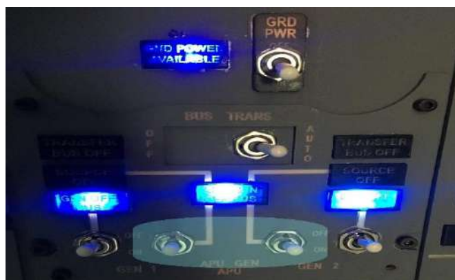
Figura.23. Interruptor Apu generator 1 y 2 en posición on ubicado en el panel.
