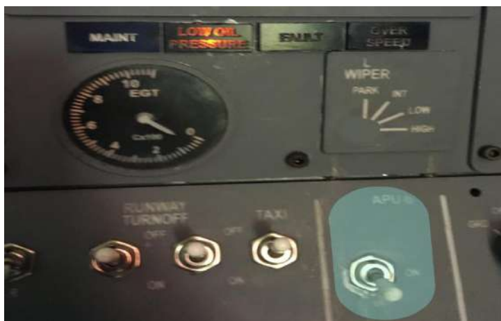
Figura. 22. Interruptor APU en posición start ubicado en el panel.
