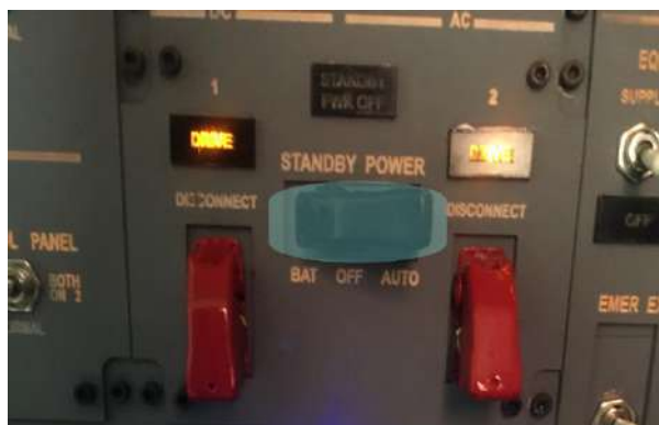
Figura. 20. Interruptor standby power en posición on
