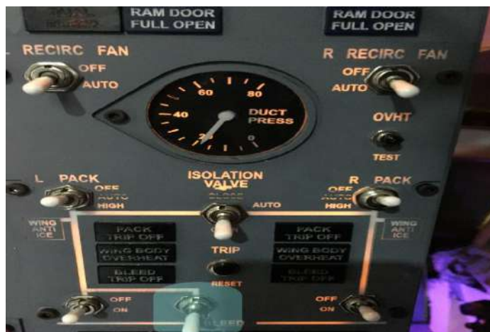
Figura.26. Interruptor APU BLEED en posición ON.
