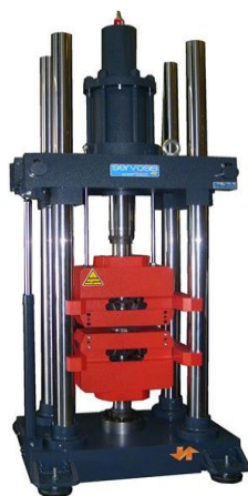
Figura 2. Máquina de ensayo de tracción/compresión/flexión electromecánica Fuente: (Servosis S.I, 2021)
