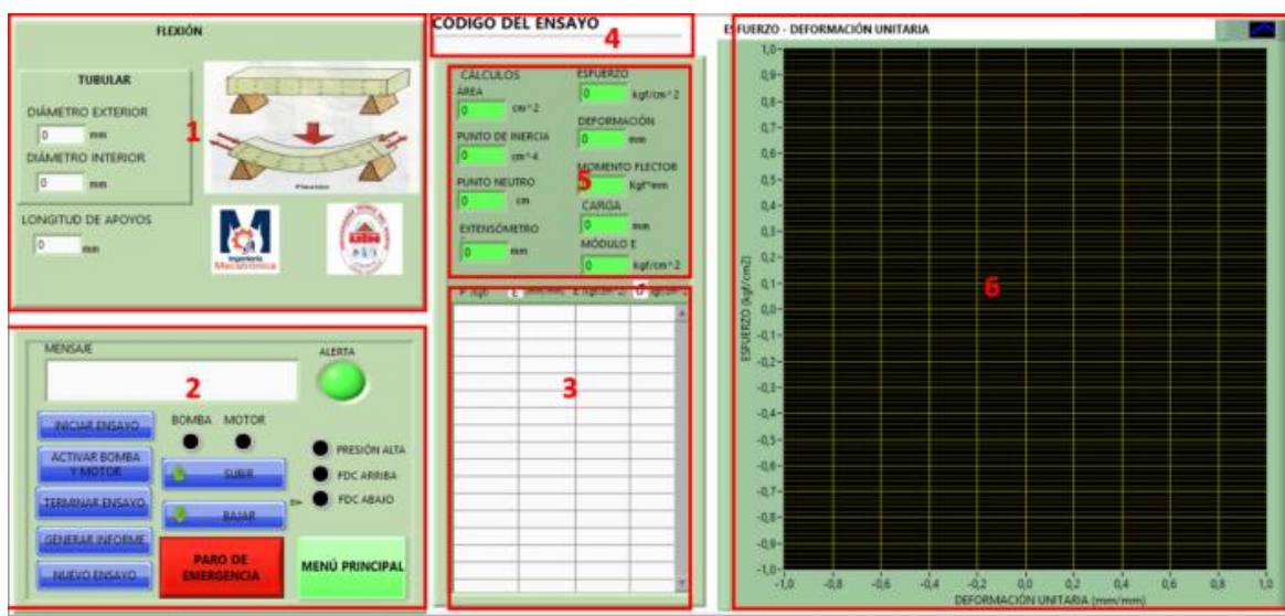
Figura 5. Interfaz gráfica en LabVIEW para una máquina de ensayos universal. Fuente: (Montalvo-Paspuezan, 2018)
