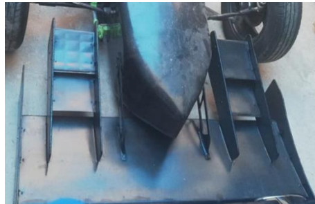
Figura 19. Alerón ensamblado en el prototipo SAE.
