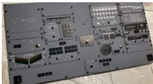
Figura. 7. Paneles diseñados y armados
