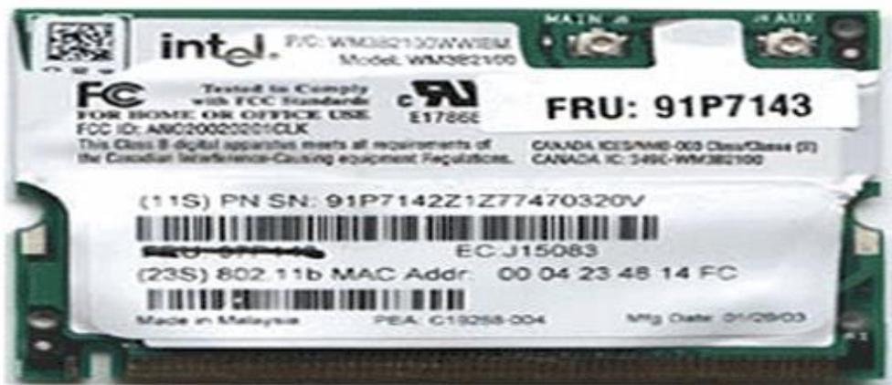
Figura # 1.35 Dirección de MAC en un mini adaptador PCI.
