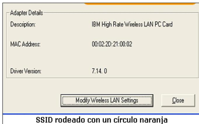
Figura # 1.33: Ejemplo de una pantalla, para entrada de nombre de la red (SSID).
