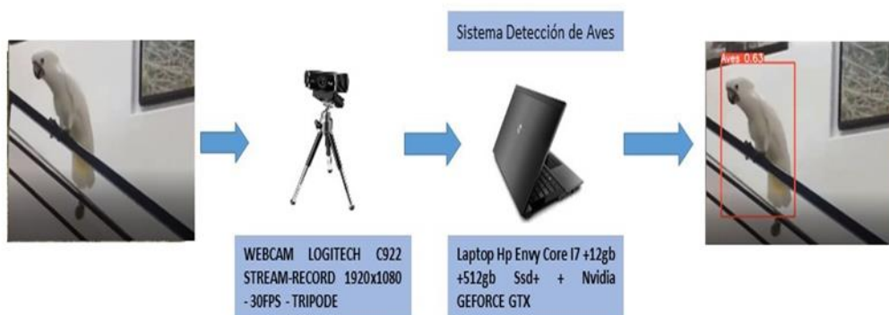
Ilustración 12 Arquitectura utilizada para la implementación del sistema de detección de aves en la Reserva Ecológica de Arenillas
