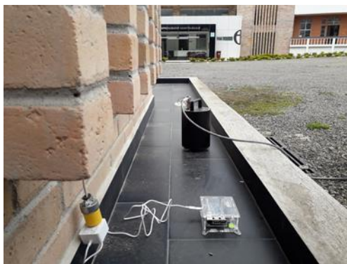
Figura 5. Sismógrafo Rasp berry Shake y sismógrafo de banda ancha Refteck para comparación de señales
