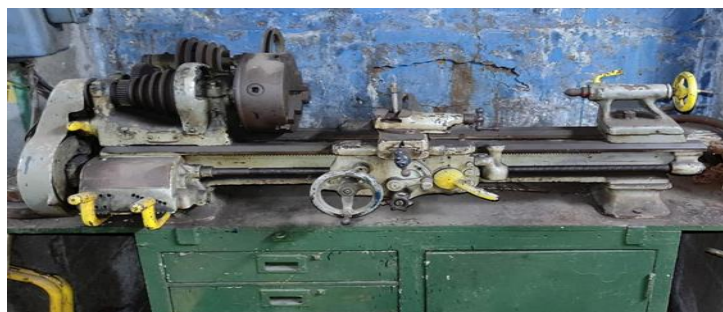
Figura 6: Torno de dique.
