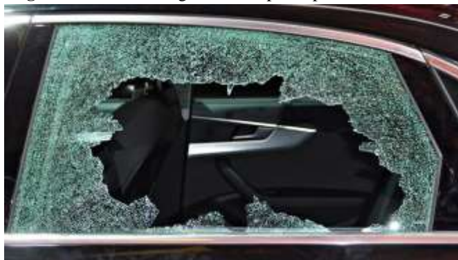
Figura 9: Vidrio de seguridad templado para automotores
