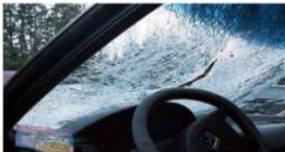
Figura 8: Vidrio de seguridad laminado para automotores
