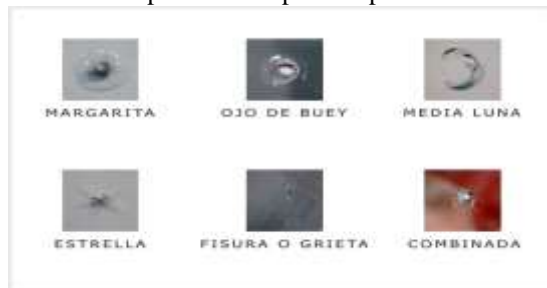
Figura 15: Tipo de fractura de parabrisas reportada por el control de calidad en auditorías
