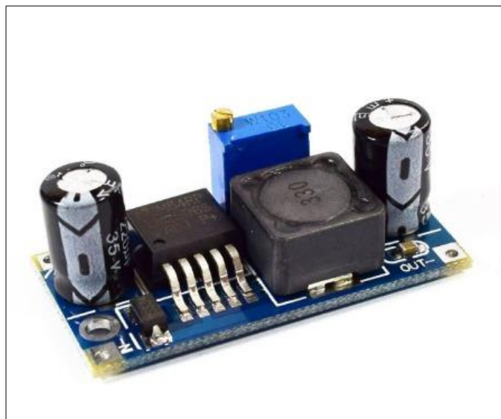
Fig. 1: Convertidor Voltaje DC-DC Step-Down 3A LM2596 Fuente: (Naylamp, 2018b)
